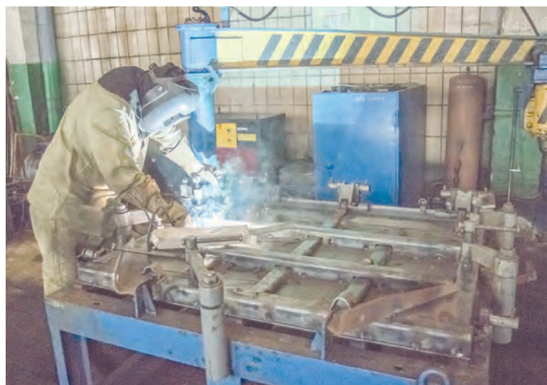
Линия по изготовлению крышек люков: работы по сборке и сварке элементов
