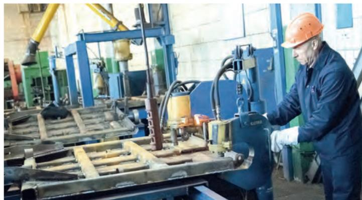
В вагонном депо Ясиноватая и ПРМЗ Дебальцево продолжаются работы по созданию новой линии по изготовлению крышек люков грузовых полувагонов. Она будет установлена в вагонном депо Дебальцево-Сортировочное.
